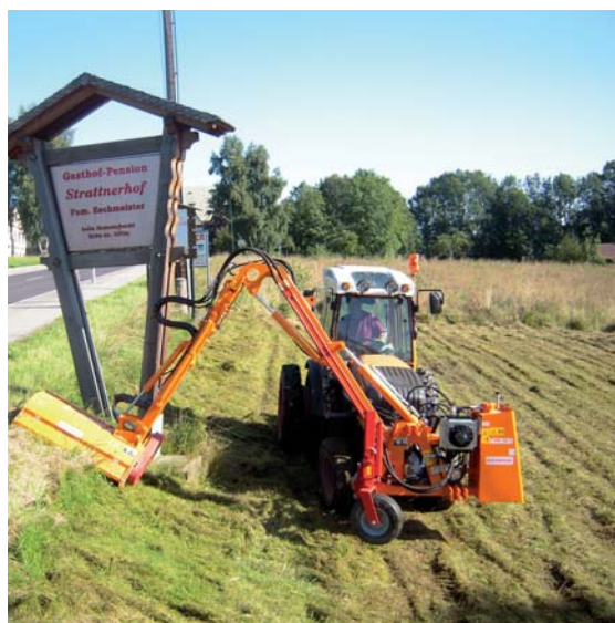
Böschungen werden mit dem neuen Mähgerät gepflegt. Bild: © Gemeinde
